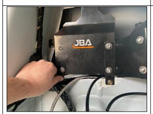
STEP 2.3 FULLY TIGHTEN THE BOTTOM RIGHT M8 X 20 SCREW ON THE COMPRESSOR BRACKET AS SHOWN. YOU WILL HAVE TO FEED THE 13MM SPANNER IN BETWEEN THE FORD BODY LOOM TO GET THE ACCESS ANGLE REQUIRED.
