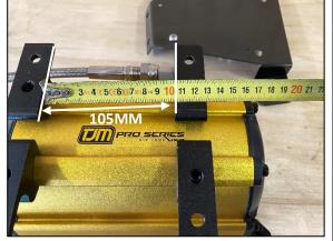
**STEP 1.6** SLIDE ON THE RIGHT END FEET AND POSITION 105MM (INSIDE TO INSIDE) FROM THE LEFT END AND TIGHTEN.
