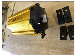
**STEP 1.3** INSTALL JBA-CB106 90 DEGREE ELBOW ON THE END OF THE TANK AS SHOWN FACING DOWN TOWARDS THE DRAIN SCREW.
