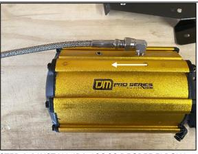
**STEP 1.4** INSTALL JBA-106 90 DEGREE ELBOW AND HOSE TO THE TOP RIGHT 1/4" GRUB SCREW AS SHOWN.
