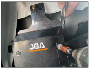
STEP 2.2 FEED THE RIGHT END OF THE TANK INTO THE CAVITY FIRST THEN SWING THE LEFT END IN. ROTATE THE TANK JOINER AROUND TO CONNECT THE COMPRESSOR AND TANK BRACKETS. INSTALL THE LAST M8 X 20 SCREW TO THE COMPRESSOR BRACKET AS SHOWN.
