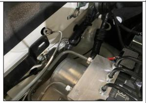
**STEP 3.3** BEND THE NUT ON WIRE AND FEED THROUGH GUARD AS SHOWN. FASTEN OUTLET SUPPORT BRACKET USING M6 X 20 SEMS FINGER TIGHT.
