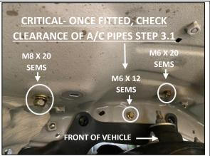
**STEP 3.2** LIFT THE COMPRESSOR BRACKET INTO POSITION IN THE ENGINE BAY. START EACH SCREW FINGER TIGHT UNDER THE WHEEL ARCH AS SHOWN. **CHECK CLEARANCE IN ENGINE BAY OF A/C PIPES**.
