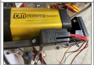
**STEP 1.3** ATTACH THE TJM RELAY USING M4 X 12 PAN HEAD AND FLANGE NUT AS SHOWN.
