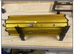
**STEP 1.6** INSTALL SECOND JBA-CB106 90 DEGREE ELBOW IN THE LHS ¼" BSP OUTLET ON THE TANK AS SHOWN FACING TOWARDS THE RHS.
