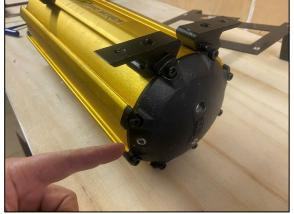
**STEP 1.2** ROTATE THE TANK SO THAT THE DRAIN SCREW IS 90 DEGREES FACING YOU AS SHOWN. SLIDE THE TANK FEET BACK ON TOP FACE (ALONG TJM STICKER)
