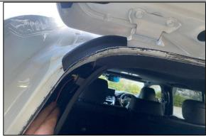
**STEP 3.2** IT CAN BE EASIEST TO RUN THE POWER FROM THE REAR JACK PANEL AREA. FROM THERE, PULL BACK THE REAR DOOR GASKET AND TRIM PANELS BACK ENOUGH TO RUN POWER WIRE UP THE SIDE OF THE VEHICLE AS SHOWN.
