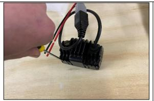
**STEP 2.1** REMOVE 4 X 2.5MM ALLEN KEY SCREWS FROM THE REAR OF THE LIGHT.
