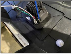
**STEP 2.8** RE INSTALL LED LIGHT USING 4 X 2.5MM SCREWS REMOVED IN STEP 2.1. ENSURE LIGHT IS SITTING FLAT AND TIGHT AND POWER CABLE IS FACING TOWARDS THE FRONT OF THE PANEL.
