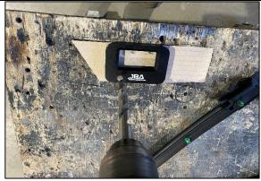
STEP 2.4 OPTIONAL STEP- ONLY COMPLETE IF FITTING JBA SWITCH TO FASCIA. TURN THE FASCIA OVER AND COMPLETE DRILLING HOLE ALL THE WAY THROUGH. TAKE YOUR TIME, DRILL SLOWLY AND STOP FREQUENTLY TO ENSURE PART DOESN'T SPIN WHILE DRILLING.
