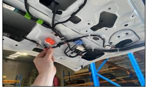
STEP 3.5 RUN POWER WIRE ALONG BODY LOOM TO REAR LATCH SECTION AND SOLDER TAIL OF LED LIGHT AS SHOWN.
