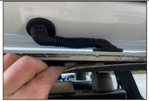
**STEP 3.3** GENTLY PULL DOWN THE ROOF LINING AND RUN ALONG TO DOOR GROMMET.
