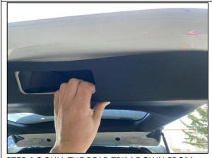
**STEP 1.3** PULL THE REAR TRIM DOWN FROM THE REAR HANDLE INSERT SECTION (STEP 1.1) TO ENABLE A GRIP ON THE TRIM FOR NEXT STEP.
