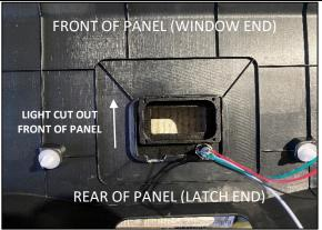
STEP 2.6 PRESS THE JBA FASCIA INTO THE REAR TAILGATE SECTION AS SHOWN. THIS WILL BE FIRM AS IT IS A SNUG FIT. ENSURE THE CUT OUT FOR THE LIGHT IS FACING TOWARDS THE FRONT AS SHOWN.
