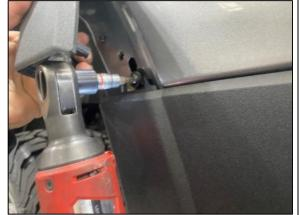
STEP 1.8 PULL BACK THE LOWER 20-30CM OF THE FLARE. YOU WILL NEED TO SQUEEZE AND PUSH THE WHITE CLIP FROM BEHIND WHILE PULLING FROM THE FRONT.
