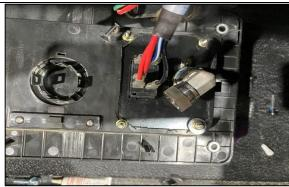
**STEP 3.1.5** FIT JBA-CB106 90 DEGREE ELBOW AS SHOWN FACING SLIGHTLY DOWN ON A 45 DEGREE ANGLE.
