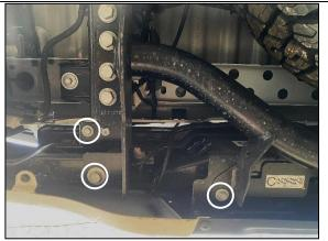
**STEP 1.2 IF FACTORY TOWBAR FITTED** REMOVE REAR BUMPER BY REMOVING 3 X BOLTS SHOWN EACH SIDE.
