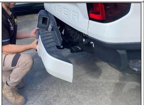
**STEP 1.4** PULL THE REAR BUMPER OFF AND SET ASIDE IN A CLEAN/SOFT SURFACE.
