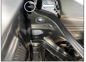
**STEP 1.16** REMOVE STEP BRACKET. YOU WILL NEED TO SLIDE THE FRONT OF THE BRACKET FORWARD TO GET THE PIN OUT AS SHOWN.
