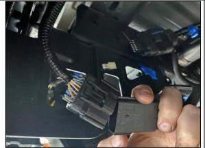
**STEP 1.3** DISCONNECT WIRING HARNESS ON PASSENGER SIDE AS SHOWN.
