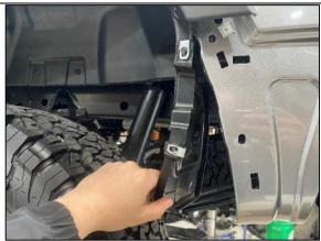
**STEP 1.15** PULL BACK INNER GUARD AS SHOWN TO GIVE CLEARANCE/ACCESS FOR NEXT STEP.
