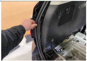
**STEP 1.14** MOVE TO THE BACK OF THE VEHICLE AND PULL BACK THE REAR DOOR SEAL.
