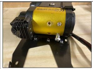
**STEP 2.2**. FIT JBA-CB104 0 DEGREE ELBOW TO THE ¼" OUTLET ON THE BOTTOM OF THE TJM COMPRESSOR AS SHOWN. ENSURE ELBOW IS FITTED USING 567 THREAD SEALANT.
