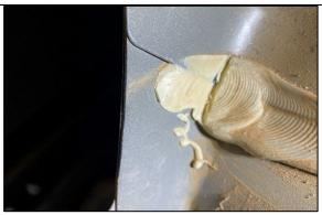
**STEP 3.2**. CHECK THE BODY SEAL ON THE WHEEL ARCH AND TRIM BACK FLAT AS SHOWN.
