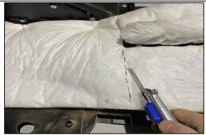
**STEP 3.1** TRIM THE SOUND DEADENING ON THE REAR QUARTER PANEL REMOVED IN STEP 1 AS SHOWN.
