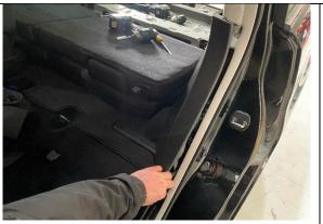
**STEP 1.13** MOVE BACK TO PASSENGER SIDE REAR DOOR AND BEGIN PULLING QUARTER PANEL BACK. WORK YOUR WAY FROM BOTTOM TO TOP.
