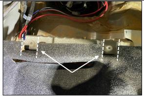
STEP 4.1.3 POSITION THE TOOL COMPARTMENT CARPET BACK IN PLACE AND TRIM EITHER SIDE OF BODY PLUGS AS SHOWN AND FOLD CARPET BACK.
