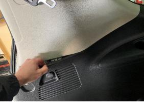
**STEP 1.16** START WORKING ALONG THE TOP OF THE PANEL ALONG THE BOTTOM OF THE WINDOW. PUSH ON THE TOP PANEL TO SEPARATE IF REQUIRED.
