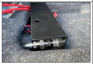
**STEP 4.1.6** CONNECT UP THE AIRLINE AND SWITCH LOOM TO JBA-CB215TASF BRACKET AS SHOWN
