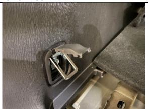
**STEP 1.11** REMOVE 2 X TIE DOWN POINTS USING 10MM SOCKET ON PASSENGER SIDE QUARTER PANEL AS SHOWN.
