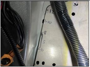
**STEP 3.4** PULL BACK THE BODY LOOM FROM THE LEFT HAND SIDE TOP AND BOTTOM LOCATIONS AS SHOWN.
